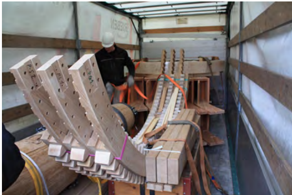
Aus diesen drei Zahnradteilen wird das Kammrad entstehen. (Foto Hans Lüthy)
