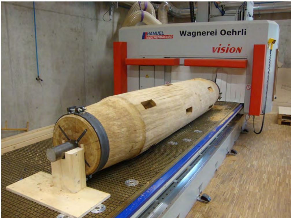
Fertiggestellte Achse für das Wasserrad. (Foto Wagnerei Oehrli)
