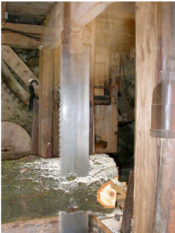
Auf und ab, auf und ab... Das Sägeblatt frisst sich langsam in den vom Sägewagen ruckweise vorgeschobenen Stamm. Je dicker der Stamm und je härter das Holz desto kleiner ist der Vorschub und desto langsamer, aber dafür auch genauer der Schnitt.
