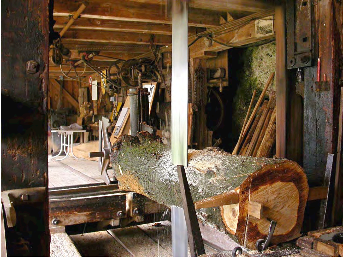
Dieser Baumstamm ist aus Hartholz (Kirsche), und deshalb ist der Vorschub auf's Minimum eingestellt, um einen möglichst schönen Schnitt zu erhalten.
