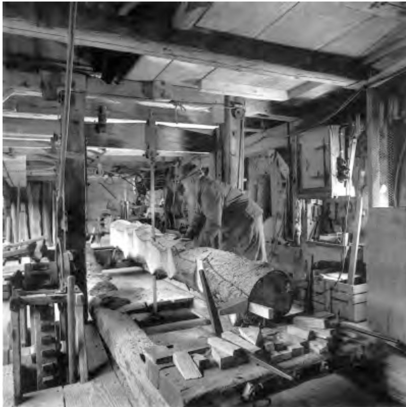
Beim Zersägen eines Baumes fällt immer ein beträchtlicher Anteil an Ausschuss an. Erst das nächste Brett wird die Stammlänge vollständig ausnutzen. Foto André Muehlhaupt.
