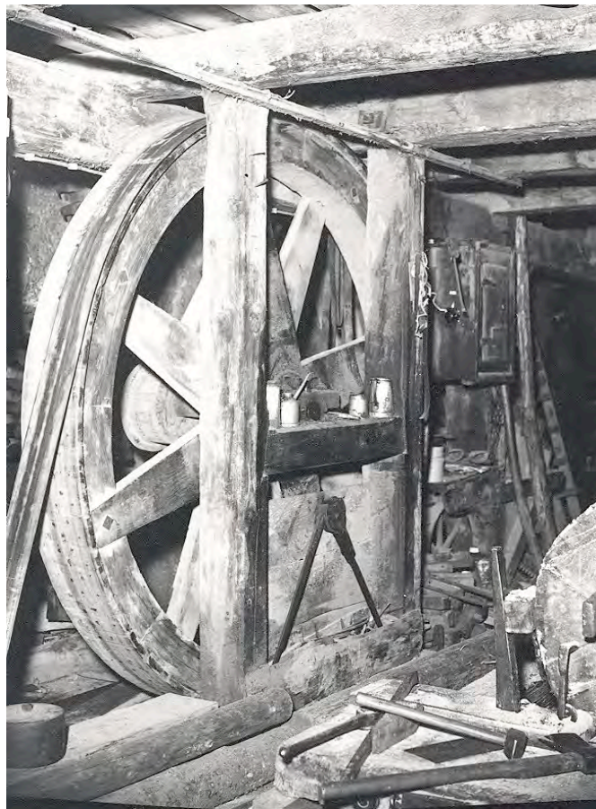
Das hölzerne Scheibenrad, welches die Energie via Transmissionsriemen auf die Antriebsachse von Sägegatter und -wagen überträgt. Foto André Muehlhaupt.
