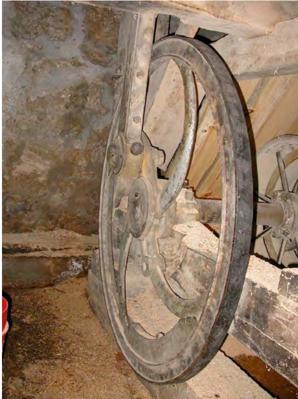
Das Exzenterrad sorgt für die Auf- und Abbewegung des Sägegatters.
