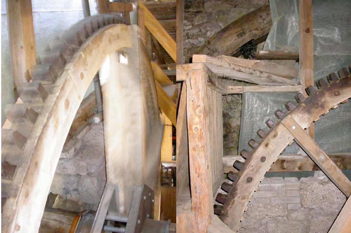
Das grosse Kammrad in Bewegung. Es überträgt die Energie vom Wasserrad auf das kleine Kammrad und von dort via Scheibenrad und Transmissionsriemen auf die Antriebsachse für Sägegatter und -wagen.
