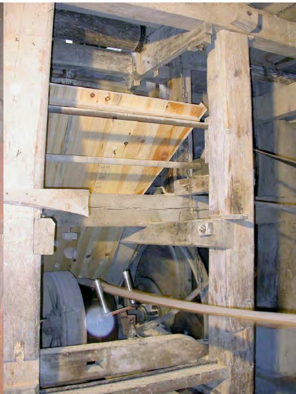
Das Sägemehl gelangt via den rampenförmigen Staubfänger in den Sägekeller. Es wird vom lokalen Metzger für die Herstellung von würzigem Speck und rassigen Trockenwürsten in der Räucherammer verwendet.
