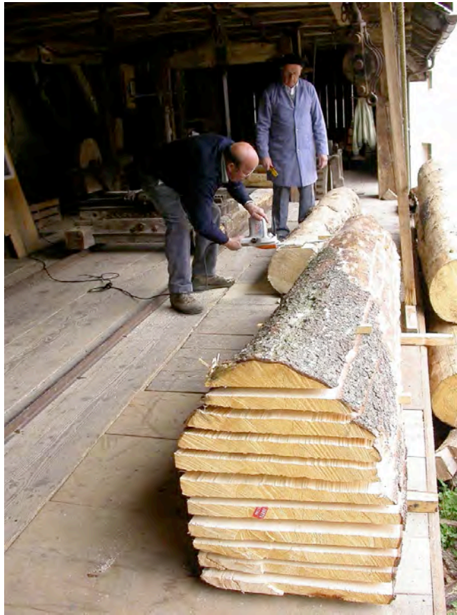
Bevor der Stamm auf den Sägewagen gehievt wird, schneidet der Säger die zuvor bestimmten Auflageflächen des Stammes auf dem Sägewagen mit der Motorsäge ab.
