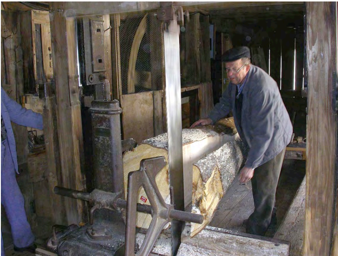
Der erste Schnitt liefert noch kein richtiges Brett, sondern lediglich Abschnitt.
