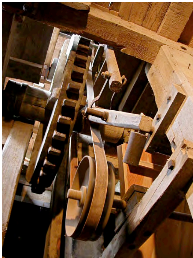
Vorschubmechanik für den Sägewagen von unten gesehen. Wie alle Transmissionsriemen ist auch der hier abgebildete aus Leder gefertigt.
