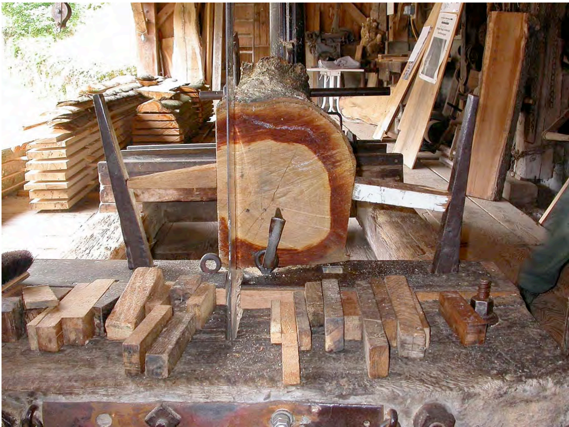
Es ist eine Freude, mitzuerleben, wie mit Hilfe der fast 200 Jahre alten Sägeeinrichtung langsam aber sicher schöne Bretter aus einem Stamm entstehen.
