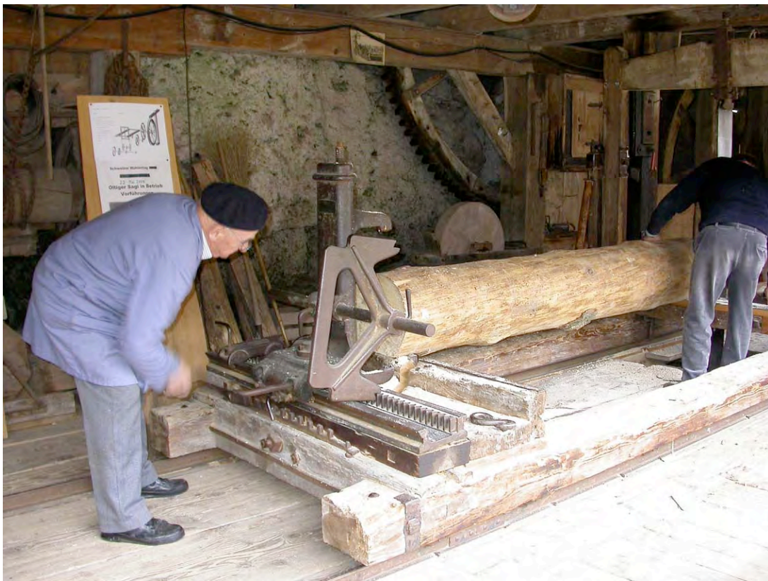
Nach dem Vorschneiden des Stammes wird er mit einer Seilwinde auf den Wagen geführt und in die bestmögliche Position gebracht, welche stets ein Kompromiss zwischen sicherer Lage und grösstmöglicher Bretterausbeute ist.
