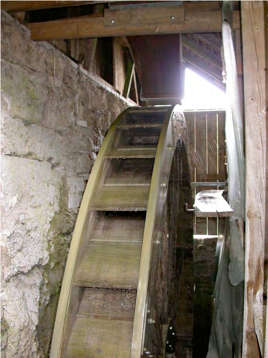
Das obereschlächtige Wasserrad der Oltinger Säge hat einen Durchmesser von 6 m und somit ein zu kleines Drehmoment, um die Säge aus eigener Kraft anzutreiben. Das Original-Wasserrad hatte 6,8 m Durchmesser.
