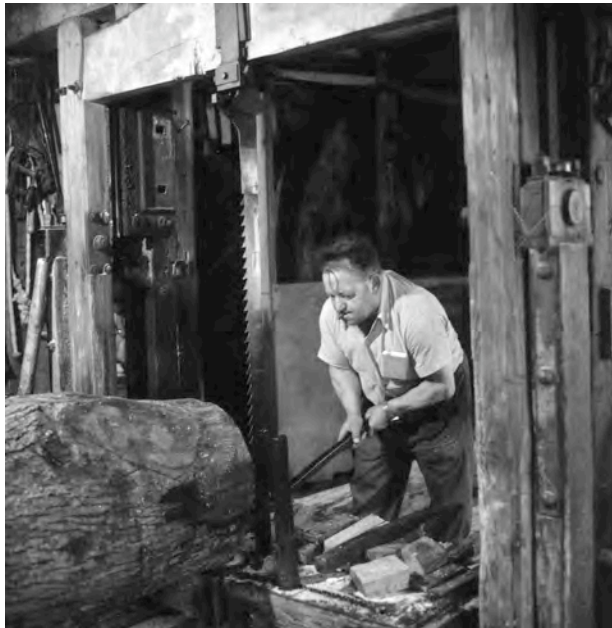
Der auf dem Sägewagen liegende Stamm muss nun richtig positioniert und verankert werden. Foto André Muehlhaupt.
