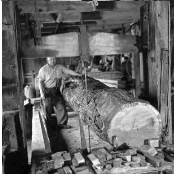
Der Sägewagen führt den Stamm in kleinen Schüben durch die Gattersäge. Das erste "Brett" wird nur Abschnitt sein. Foto André Muehlhaupt.
