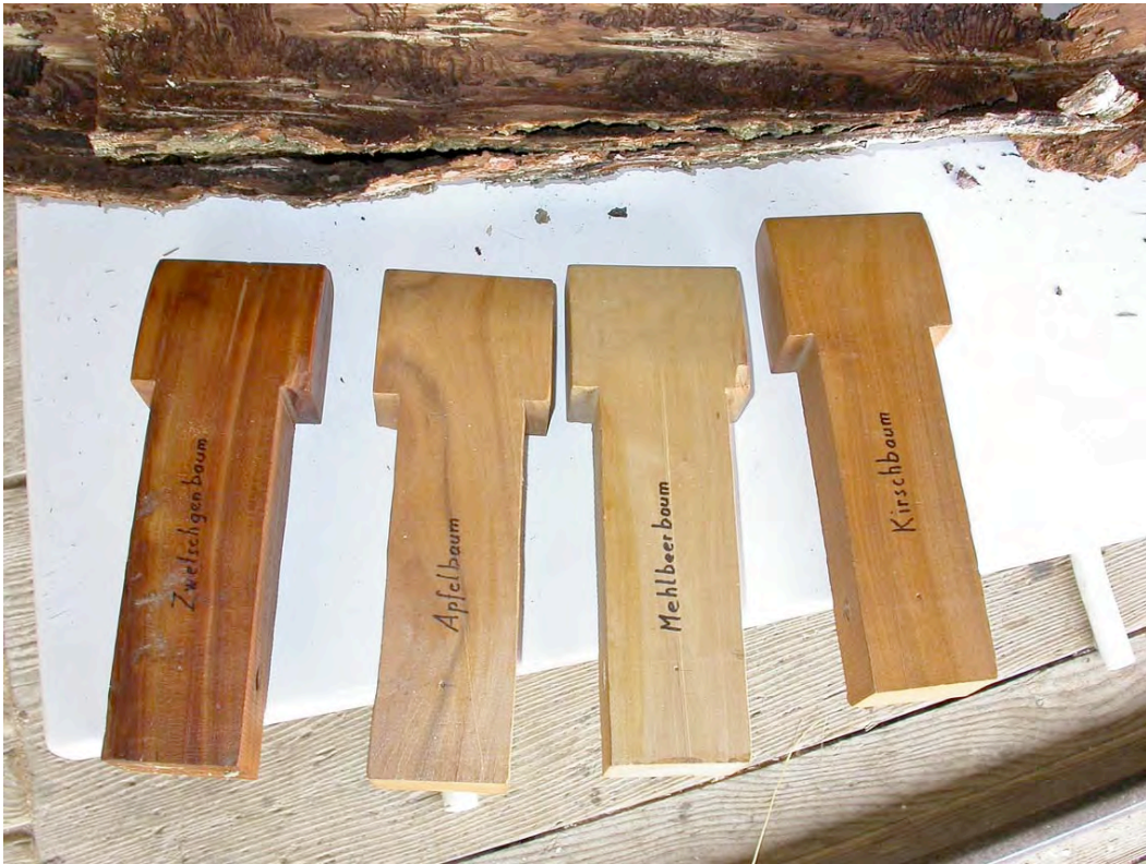
Die Zähne der Kammräder müssen der hohen Beanspruchung wegen aus Hartholz (Zwetschge, Apfel, Mehlsbeere oder Kirsche) hergestellt werden.
