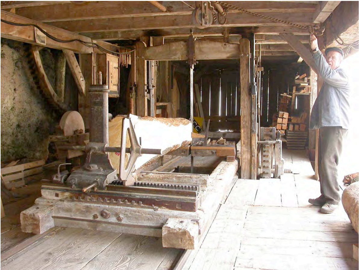
Der bewegliche, auf zwei Eisenschienen liegende Sägewagen. Auf ihm werden die Stämme eingespannt.
