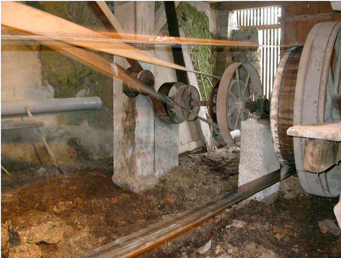
Antriebsachse (Transmissionsachse) im Sägekeller (hier mit Wasserschaden). Dieses Wirrwarr aus drehenden Rädern und flatternden Riemen ist sozusagen das Gehirn der Säge. Es sorgt für den Antrieb und den koordinierten Bewegungsablauf des Sägevorgangs.
