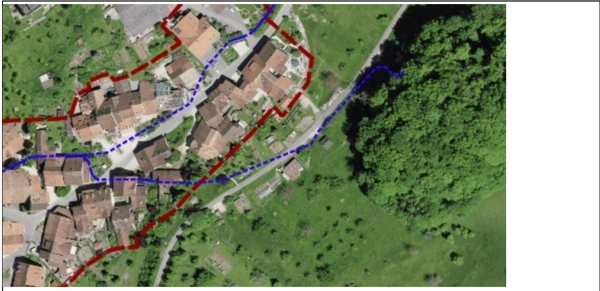
Abbildung 19: Streckenverlauf Mülibächli (gestrichelte Linie: der Bach fliesst eingedolt; durchgezogene Linie: der Bach fliesst offen)
