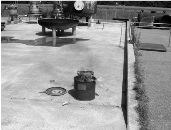
Wird das Fass offen stehen gelassen, so entzündet sich das Gemisch innert Minuten von selbst.
