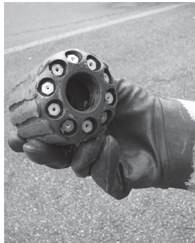
Durch diese Düse schiesst mit Hochdruck das Wasser und schiebt den Schlauch vorwärts.
