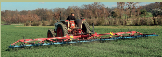
Abb. 1 : Hackstriegel mit grosser Arbeitsbreite
