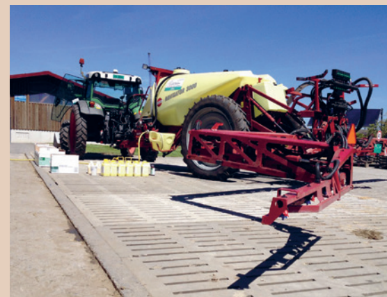
Spritzenreinigung auf einem Platz, der in eine aktive Güllegrube entwässert, St. Berger
