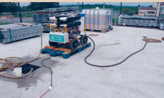
Mit der Ultrafiltrations-Anlage lassen sich grosse Waschwassermengen behandeln, CCD
