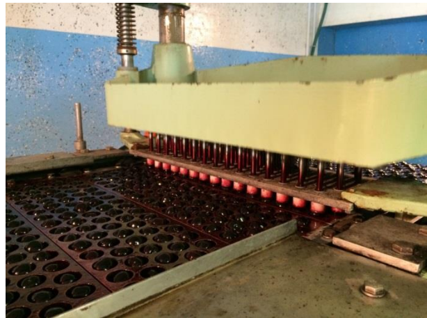
Abb.44: Konservenkirschen mit Kaolin behandelt, eingereicht auf dem Weg zur Stöpselmaschine zur Entsteinung
