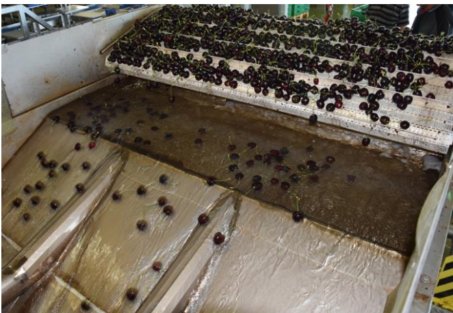
Abb.23: Versuch 2017-2: Transport mittels Wasser zur Stieltrennung
