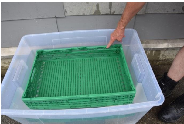
Abb.35: Versuch 2017-5: Einfache Wascheinrichtung für IFCO-Gebinde
