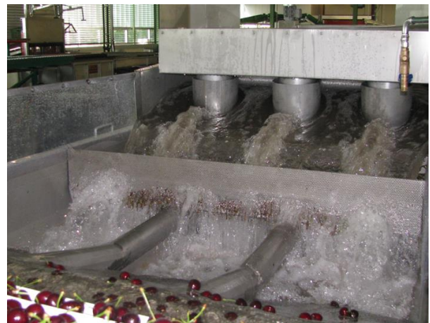
Abb.24: Versuch 2017-2: Weitertransport mittels Wasser nach der Stieltrennung
