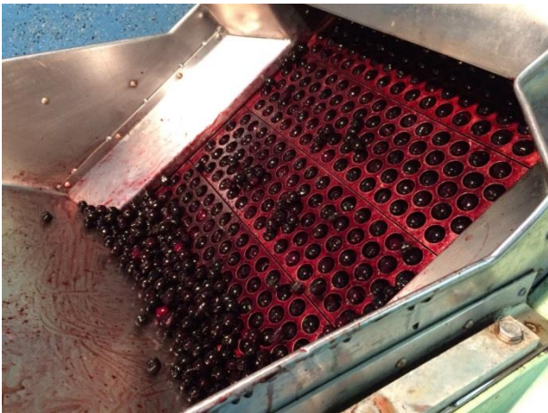
Abb.43: Konservenkirschen mit Kaolin behandelt, in der Wanne der Entsteinungsanlage
