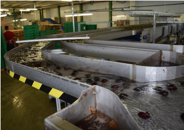
Abb.25: Versuch 2017-2: Transport in Wasserkanal zur Kalibrierung
